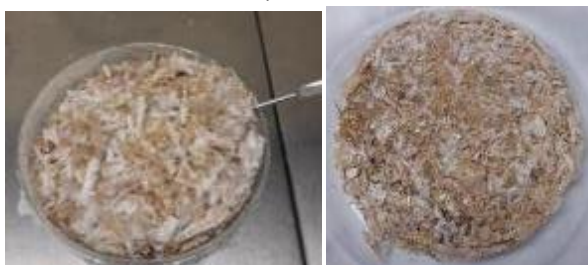
Figura 61. Torta de la mezcla de fibras de caña antes de llevar al secado
