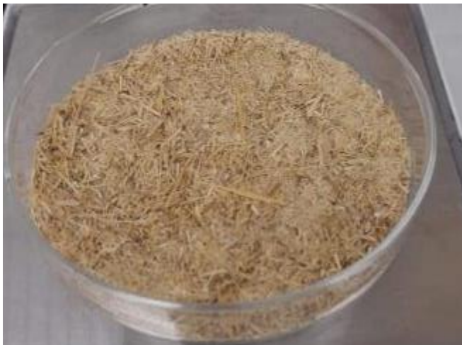
Figura 18. Serrín de la corriente de fibras de caña
