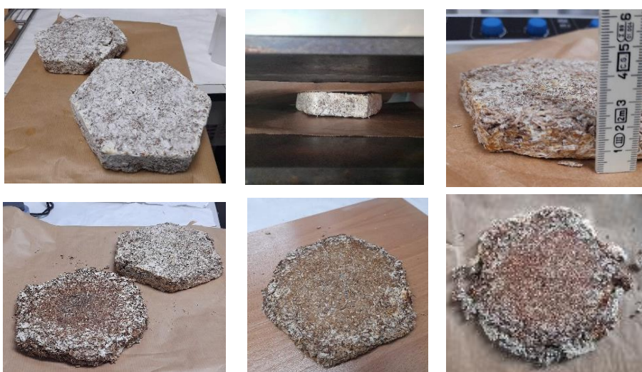
Figura 41 Antes (arriba izda.), durante (arriba centro) y después (las demás) del prensado en caliente de las dos muestras
