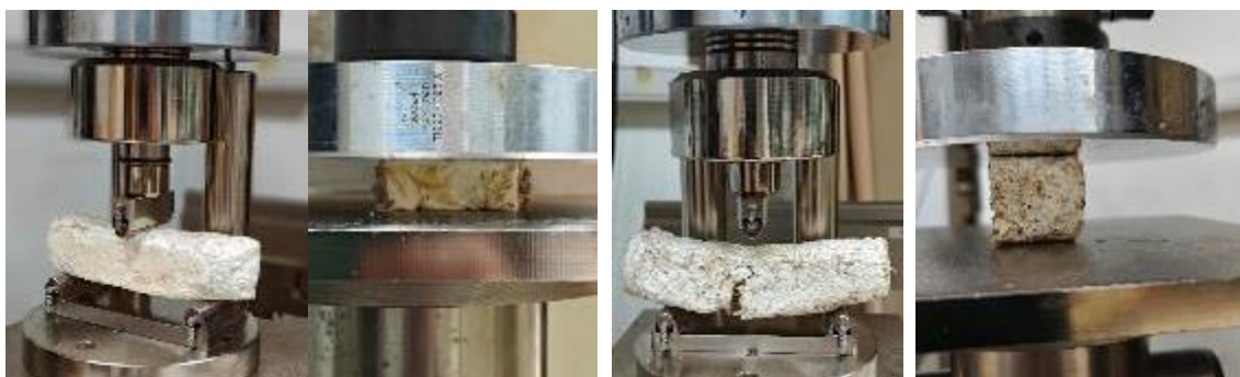
Figura 57. Tracción y compresión de Izquierda Reishi-cañamo y derecha Pleurotus-pino
