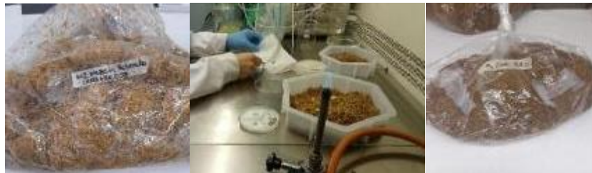
Figura 31. Esterilización del sustrato en bolsas para autoclave (izqda.) e inoculación en los moldes (centro) y bolsas perforadas (dcha.)
