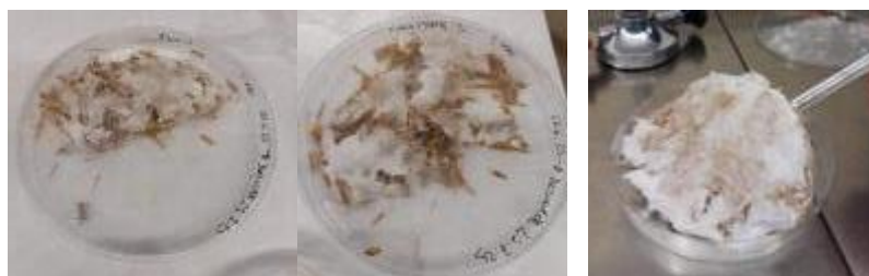
Figura 66. Tras dos Semanas después del desmolde (izqda.), se mezcla con la otra corriente de fibra de caña (centro) para fomentar la obtención del biomaterial (dcha).
