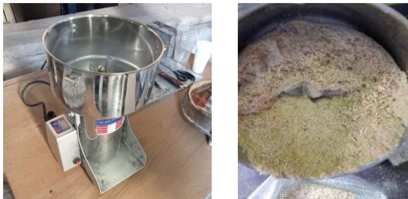
Figura 26. Izqda. Molino para la trituración del grano. Dcha trituración de la fibra de caña en molino
