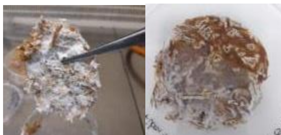
Figura 59. Biomaterial fabricado a base de micelio, antes del secado, en una mezcla de fibras de caña de distinto tamaño con Pl. ostreatus
