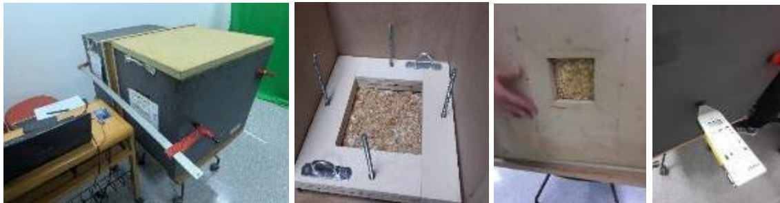
Figura 54. Izda. Montaje complete, centro colocación de la muestra, derecha introducción del sonómetro
