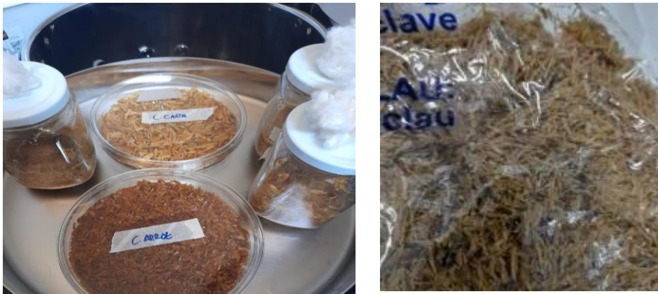
Figura 21. Izq. sustratos individuales siendo introducidos al autoclave en los recipientes acorde a su volumen. Dcha sustrato de caña (mezcla fibra y serrín) después de la esterilización por autoclave en bolsas para tal fin
