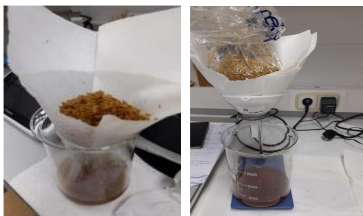
Figura 24. Métodos para eliminar parte de la humedad en los sustratos
