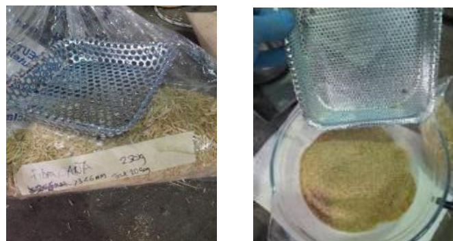
Figura 27. Izqda. Fracción caña tamizado fibras < 6\text{ mm} y > 3\text{ mm} . Dcha. Polvo cáscara de arroz tamizado < 2\text{ mm}
