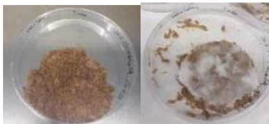
Figura 65. Izqda. material tras desmolde y preparación para mantener en condiciones de cultivo. Dcha. Tras 1 mes de cultivo, el material está listo para el secado
