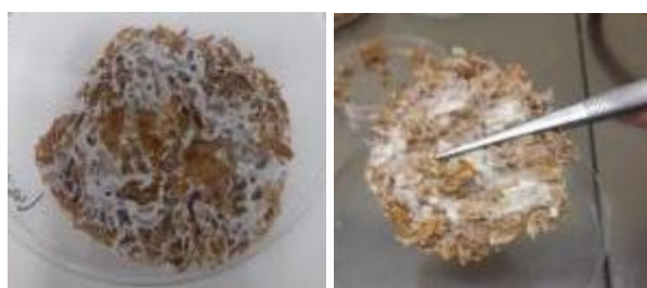
Figura 60. Biomaterial fabricado a base de micelio, antes del secado, en una mezcla de cáscara de arroz y fibra de caña (tamaño serrín) con Pl. ostreatus
