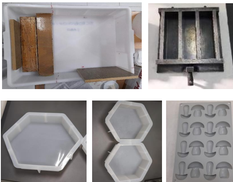
Figura 12. Moldes utilizados en la fabricación de los biomateriales, tanto demostrativos como para ensayos
