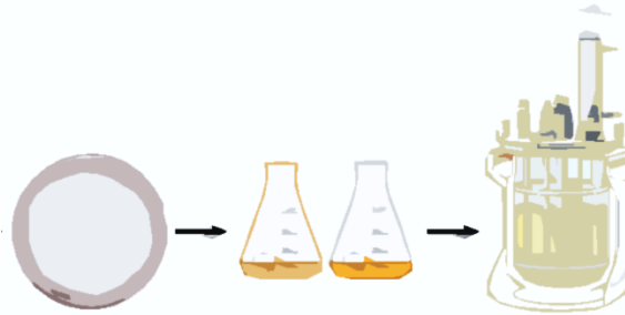
Figura 9 Esquema de cultivo sumergido (fase líquida), desde la placa en agar al crecimiento en reactor. Fuente: Enhancing Biomass-Exopolysaccharides Production of Lignosus rhinocerus in a High-Scale Stirred-Tank Bioreactor and Its Potential Lipid as Bioenergy. Siti Rokhiyah Ahmad Usuldi
