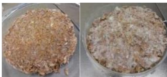
Figura 62. Torta de la mezcla de cáscara de arroz y fibras de caña (serrín) antes de llevar al secado
