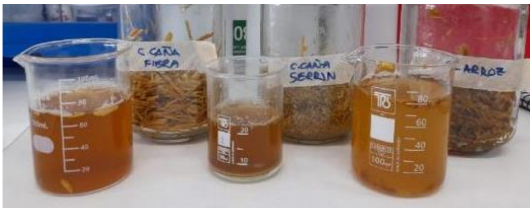
Figura 23. Líquido para la medición del pH, recogido tras la adecuación del sustrato
