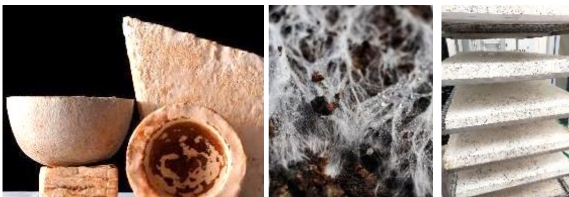
Figura 5. Biocomposites de Biohm a base de cáscara de cacao y naranja, Sustrato con micelio GIY de KINECO y paneles de MYKOR (proyecto INBUILT)
