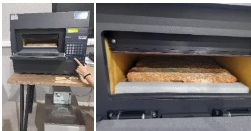
Figura 53 Equipo para la determinación de la conductividad térmica e introducción de la muestra
