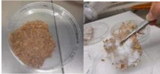
Figura 64. Izqda. material tras desmolde y preparación para mantener en condiciones de cultivo. Dcha. Tras dos semanas de cultivo, el material está listo para el secado
