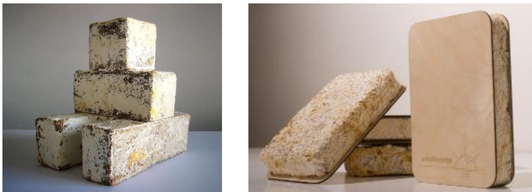
Figura 1. De izq. a dcha, Bloques-ladrillo a base de micelio de MYCOWORKS (2016) y Paneles para aislamiento de ECOVATIVE
