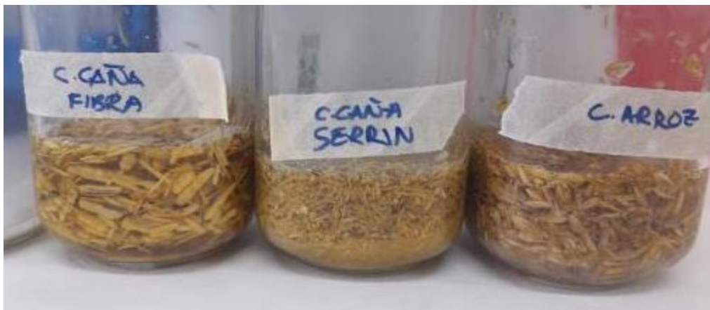
Figura 22. Sustratos en remojo durante al menos 18h en la solución alcalina
