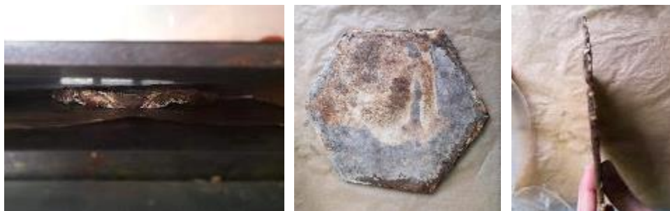
Figura 36. Prensado en caliente de la muestra hexagonal, quedando densificada
