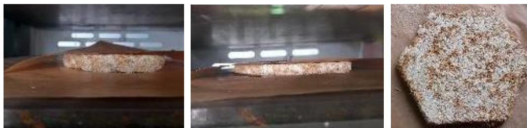
Figura 46. Hot Press Trametes versicolor caña y cáscara de arroz
