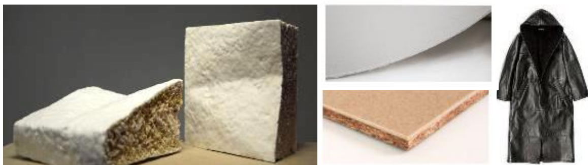
Figura 4. Productos comerciales de MOGU, izda panel de aislamiento acústico (no prensado) centro Suelos resilientes (prensados) abajo “Tiles” arriba “Flex”. Fuente: mogu.bio Derecha EPHEA: abrigo de la colección de Balenciaga
