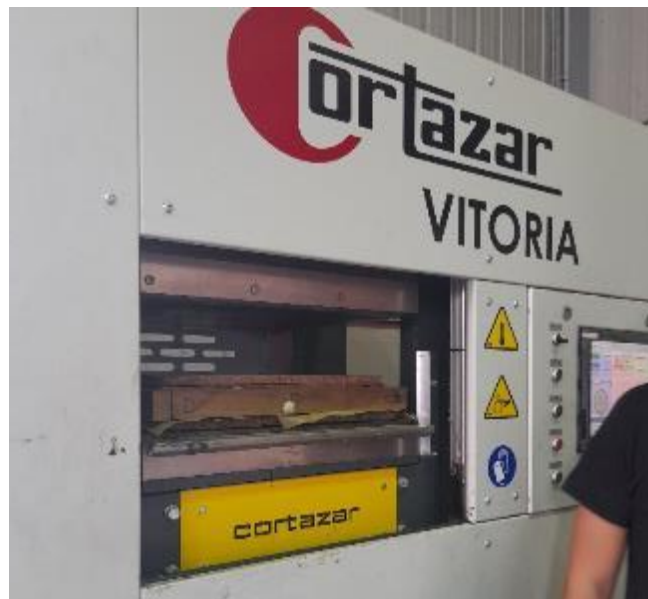
Figura 11. Hot- Press en las instalaciones de AIDIMME
