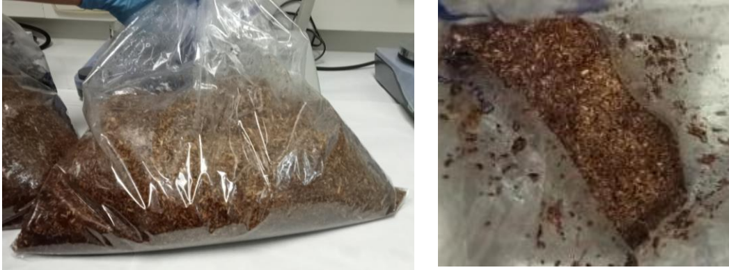
Figura 25. Tratamiento del sustrato Pino halepensis en inmersión alargada en agua
