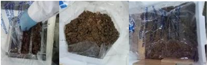
Figura 34. Moldeado final para el cáñamo con micelio
